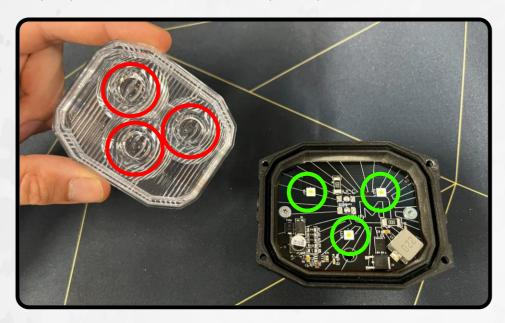
5. PLACE THE LENS HOLDER OVERTOP OF THE NEW LENS. MATCH THE ALIGNMENT LOCATORS ON THE HOLDER TO THE HOLES ON THE HOUSING. THE DESIGN ON THE SIDE OF THE HOLDER AND HOUSING SHOULD MATCH UP AS WELL
